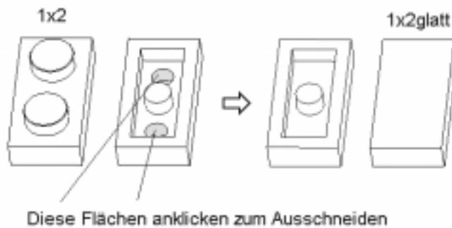
**Abbildung 27** : Entfernen des Formelements mit **[Ausschneiden]**
